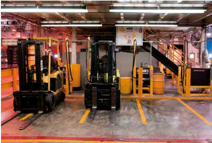
Praxisbeispiel 1: Aufbau von Ladestationen unterhalb einer Bühne
