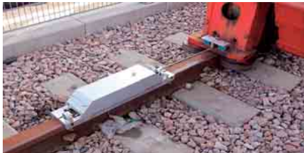
2 Messung der Schienengeometrie im belasteten Zustand (der Schienennesswagen wird vom Kran gezogen)
