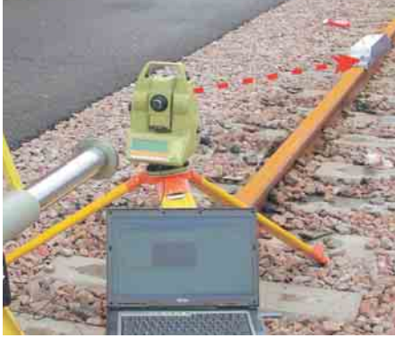
1 Kinematische Erfassung eines Schienennesswagens mit einem Tachymeter
