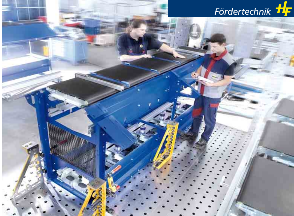
Die Vormontage der Sorter-Teilmodule im Werk ermöglicht einen schnelleren Aufbau am Einsatzort
