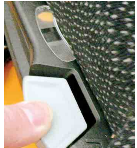
❷ Absenken eines luftgefederten Sitzes; die Sitzeinstellung ist in Ordnung, wenn sich der gelbe Zeiger in der Mitte des klaren Sichtfeldes befindet
