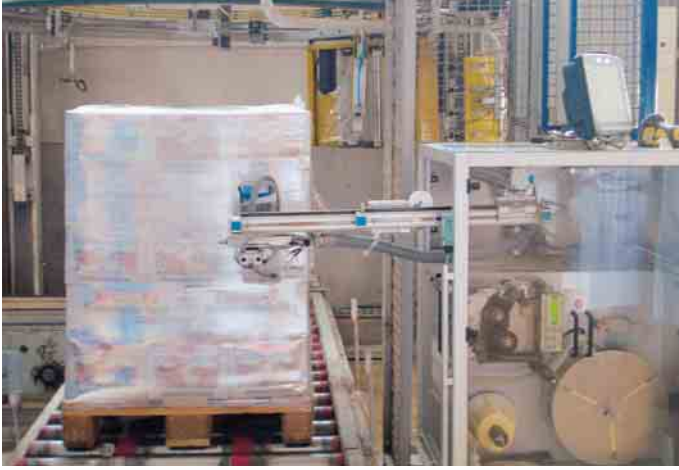
Palettenetikettierer PE-522: kompakt und RFID-fähig (Bild: ICS)
