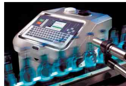
Inkjet-Codierer der Linx-Serie beschreiben unterschiedlichste Materialien, wie Folien, Glas, Metall, Acryl und Karton
