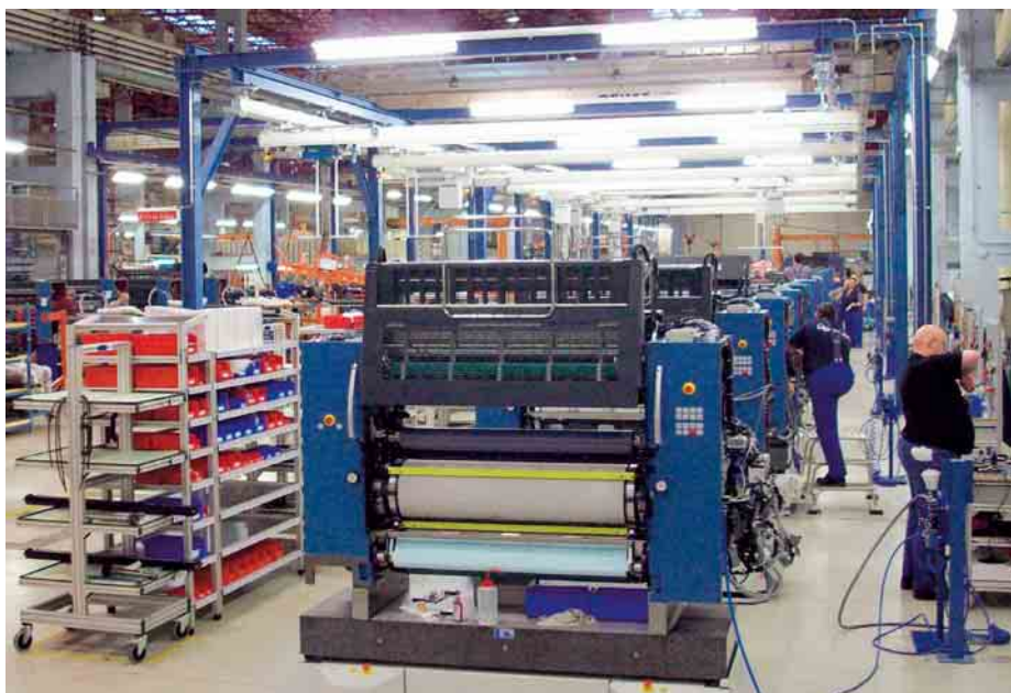
② Pilotsystem der getakteten Druckturm-Fließmontage mit FTS kurz nach der Inbetriebnahme
