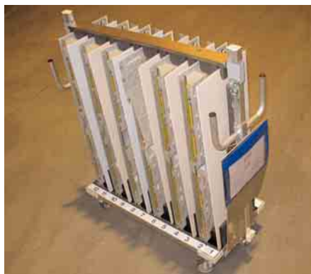
⑥ Aufnahmevorrichtung für Fußverkleidungen, die in Einbaureihenfolge geordnet sind (Bilder: Airbus)
