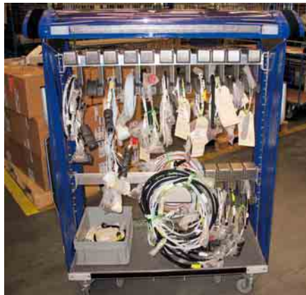
④ Rollbares LHM zur Aufnahme von un- verpackten Kabelbäumen
