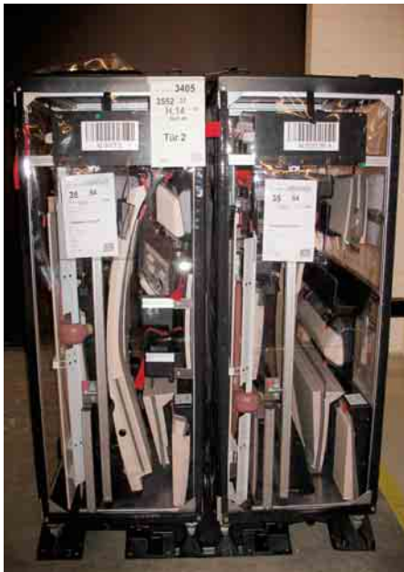
③ Rollbare LHM inklusive Palette für die Aufnahme von Türrahmenverkleidungen
