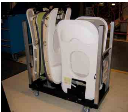
⑤ LHM für Notausstiegstüren und -verkleidungen auf Rollpalette ohne Verpackung zum direkten Einbau
