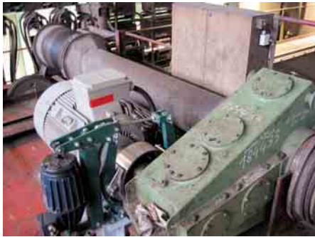
1 Umgebautes Hubwerk eines Zangenkranes 10 t x 16 m
