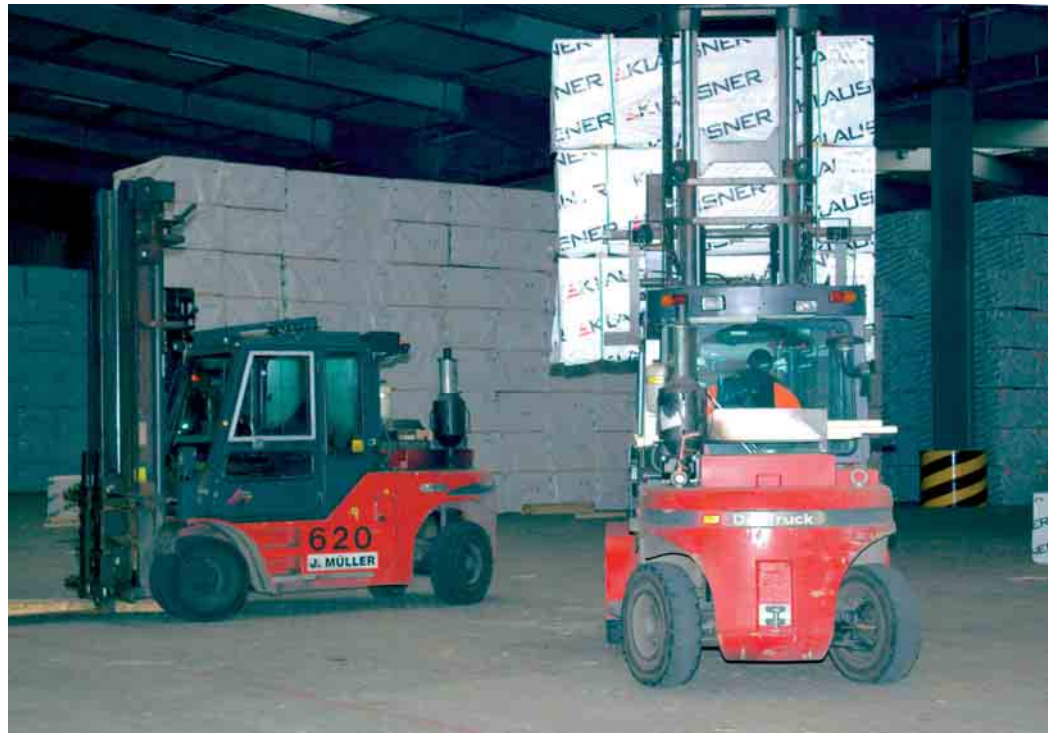
Für das Verladen von Holz im Müller Breakbulk Terminal stehen 22 DanTruck-Stapler mit einer Tragfähigkeit von 7 t bereit
