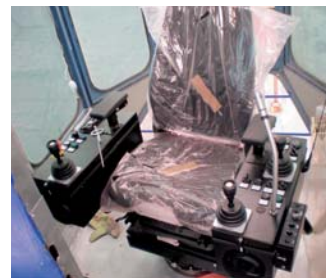
Mit Komfort: Neu gestalteter Steuerstand in der Krankabine
