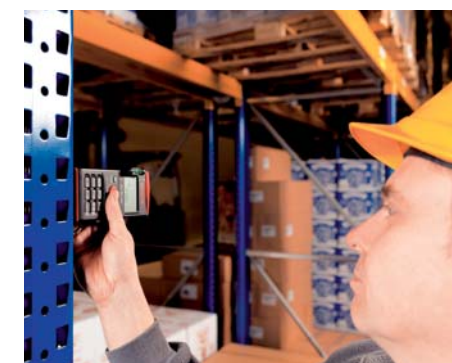
Ermittlung der lichten Weite eines Regalfachs mit einem Laser-Entfernungsmesser
