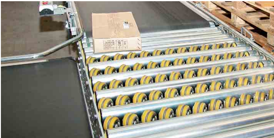
8 Die Schwenkröllchenleisten schwenken blitzschnell um 45°, wenn der Barcode am Karton den Ausschleusvorgang indiziert. Dieser Prozess funktioniert bei normal großen Kartons ebenso zuverlässig wie bei sehr kleinen oder großen Kartons
