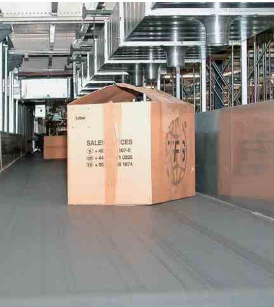
5 Mit 1,20 m extra breit und für Kartons jeder Größe geeignet ist die Gurtförderstrecke für die Leerkartons zur Presse
