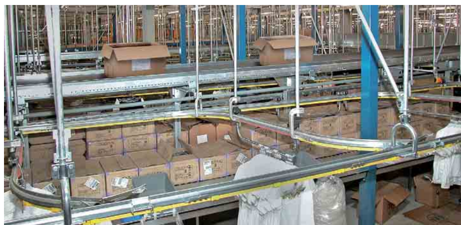
4 Der Liege-Hänge-Bereich, Schnittstelle zweier Fördertechniken: Die in Kartons angelieferte Liegeware wird auf Bügeln an die Trolleys gehängt, der oben verlaufende Gurtförderer dient dem Abtransport der leeren Kartons
