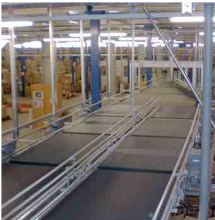
9 Aus zwei mach eins: Linienzusammenführung mit Gurtabweiser, realisiert von Transnorm in der Karton-Förderstrecke
