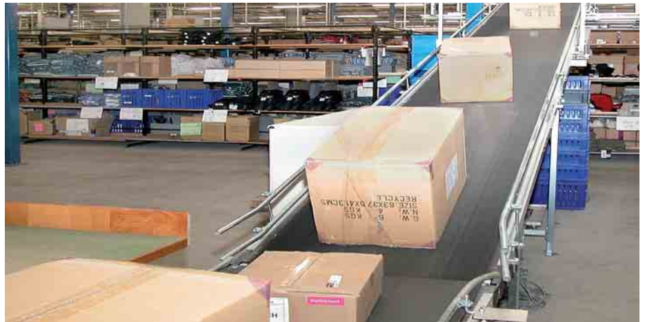
6 Auf dem Weg zum Warenausgang: Um den notwendigen Abstand zwischen den Kartons zu erzielen, bewegt sich das Transportband der Steigungsstrecke mit etwas höherer Geschwindigkeit
