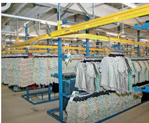
3 Die Trolleys mit Hängeware werden entweder weiter sortiert, auf die unterschiedlichen C&A-Stores verteilt oder direkt in den Warenausgang transportiert
