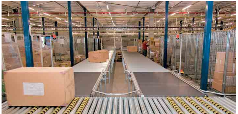
7 Per Verteilweiche werden die Kartons auf die unterschiedlichen Warenausgangsbereiche sortiert
