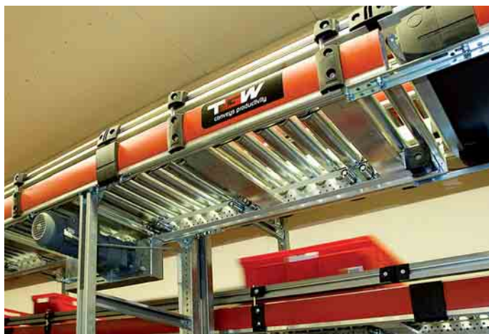
3 Gemischter Behältertransport auf dem TGW-Fördersystem
