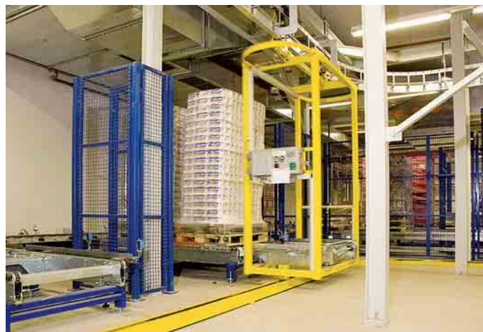
2 Das Elektrohängebahn-System befördert 400 Paletten pro Stunde
