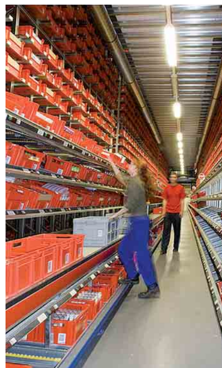
5 Kommissionieren im Weiterreichsystem (Bilder: TGW Mechanics)
