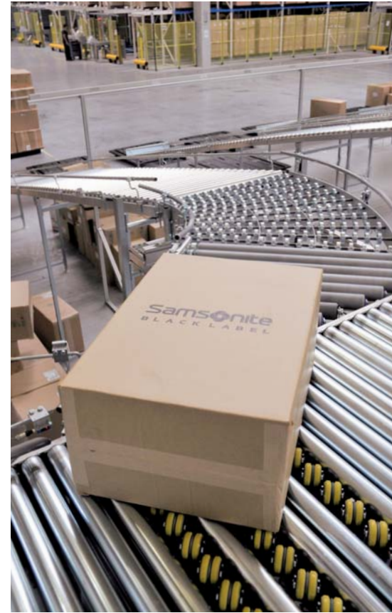
4 Zuverlässig und unauffällig: Ausschleusung auf eine der zehn Zielbahnen
