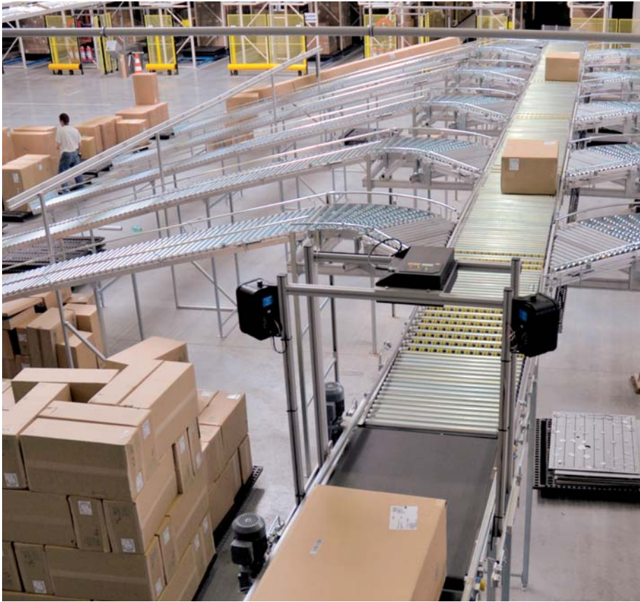
3 Sortierlinie RC22: keine „Blackbox“ mehr, sondern ein modularer Systembaukasten mit hoher Flexibilität
