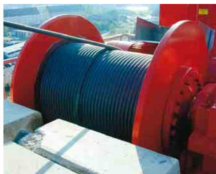
1 Hubwerk eines Turmdrehkrans mit mehrlagig bewickelter Trommel
