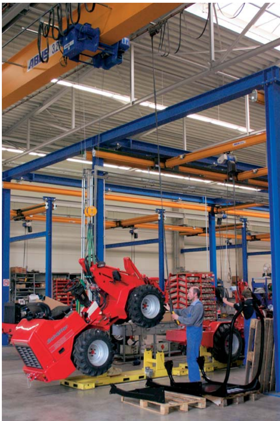
Der fertig montierte Lader wird auf dem Gleiswagen aus dem Fertigungsbereich geschoben und von dort mit einem Einträger-Laufkran angehoben und auf den Boden gestellt
