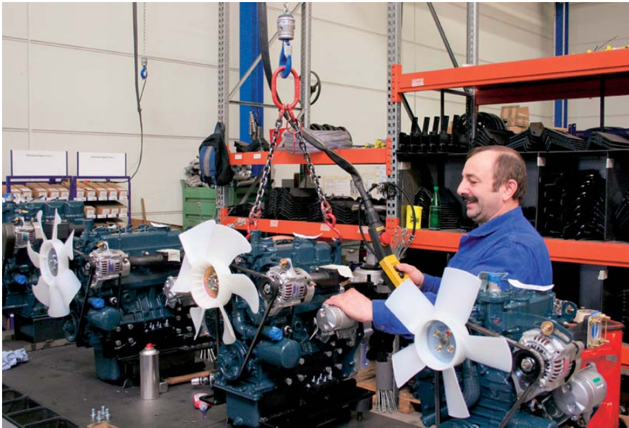
Alle HB-Krane, wie hier im Motorenbau, sind manuell verfahrbar. Der Mitarbeiter bedient mit einer Hand den zweistufigen Hängtaster und führt mit der anderen Hand die Last
