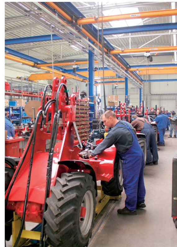
In der Fertigungslinie werden u. a. die Motoren eingebaut. Die aufgebockten Einträgerkrane EHB-X ermöglichen den Vorteil größerer Hubhöhen
