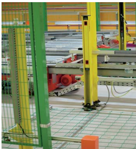
④ Die Muting-Funktion der Mehrstrahl-Sicherheits-Lichtschranken COMPACTplus sorgt für permanenten Personenschutz bei ungehindertem Materialfluss
