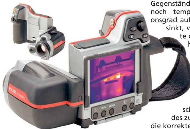
1 Bedienungsfreundliche Wärmebildkamera T335 mit einer Infrarot-Auflösung von 320 x 240 Pixel; sie ermöglicht eine schnelle und genaue Diagnostik bei Industrieanwendungen im Temperaturmessbereich zwischen -20 °C und 650 °C
