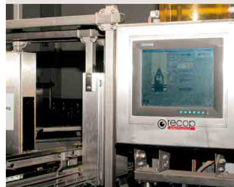
Sämtliche Flaschen und Kästen durchlaufen die Bildererkennung, in der 150 unterschiedliche Kästen- und 100 Flaschenmuster hinterlegt sind
