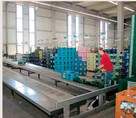
Die fertigen, sortenrein gefüllten Getränkekästen werden an den vier Sortierbahnen ausgeschleust
