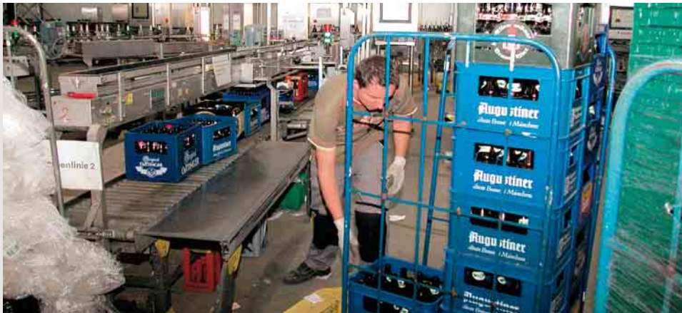
Aufgabe der Getränkekästen: Vollständige und sortenreine Kästen werden gleich komplett durch die Anlage geschleust
