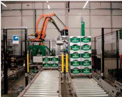
Die vier gängigsten Flaschensorten werden per Roboter sortiert. Der Roboter füllt die Flaschen in eine leere Kiste (r.), die er anschließend auf die Palette mit den gefüllten Kästen (l.) setzt
