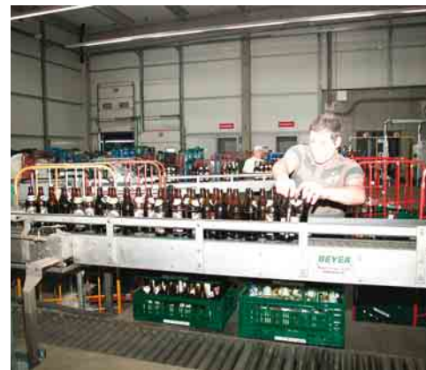
Einzelflaschenaufgabe: Die aus den Filialen auch in EPS-Obstkisten angelieferten Flaschen werden manuell auf die Fördertechnik aufgesetzt
