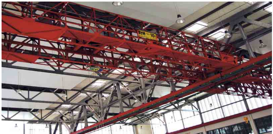
Überzeugende Optik: Durch das Multi-Receiver-Konzept für die Funkfernsteuerung konnte auf die Verlegung von Schleppleitungen verzichtet werden
