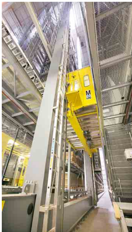
Die zweisäuligen Regalbediengeräte vom Typ MTwin weisen besonders hohe Tragfähigkeiten ohne Einbußen hinsichtlich Geschwindigkeit und Beschleunigung auf
