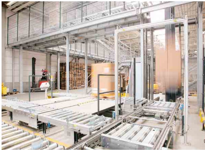
Die Paletten werden im Wareneingangsbereich geprüft und fahren dann über den Vertikalumsetzer in das Lager
