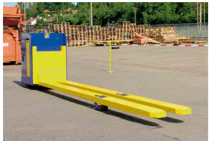
2 Elektro-Quersitz-Niederhubwagen EFP 3500 mit 4 000 mm langen Gabeln
