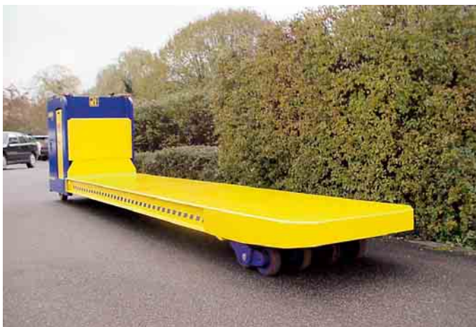
1 Elektro-Deichsel-Niederhubwagen EFP 5000 mit Lastplattform (Länge 4 000 mm)
