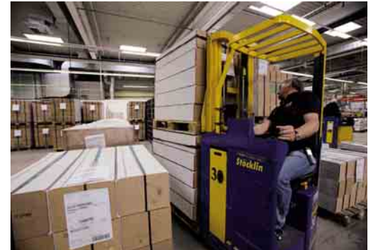
④ Elektro-Quersitz-Hochhubwagen mit Radarmhub EFI 1500 für Doppelstockeinsatz 2 x 1400 kg bei einem Lastschwerpunkt von 700 mm (Bilder: Stöcklin)
