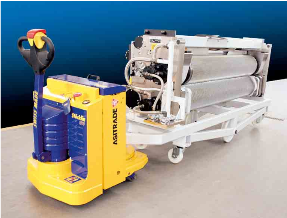
③ Elektro-Deichsel-Niederhubwagen EDP 2000 mit Drehkranz als Schlepper
