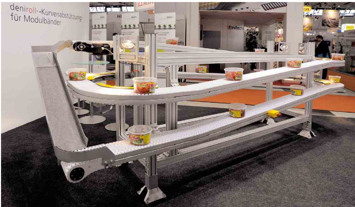
5 Mit sechs 90°-Kurven ausgeführter Wendelförderer
