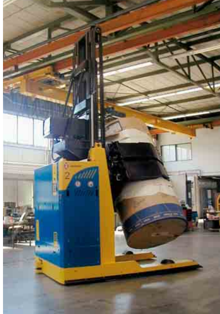
Sonderausführung: FTF mit Klammeregreifer (Bild: E&K)
