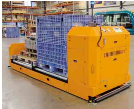
FTF mit Rollenbahn beim Transport von Paletten und Gitterboxen (Bild: Frog)
