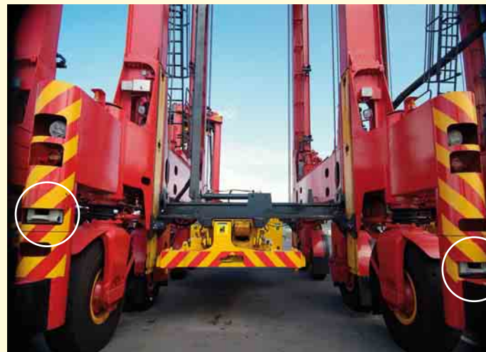
Fahrwegüberwachung und Positionserfassung von Containern für das automatische Pick & Place – beides gelöst mit insgesamt vier LMS pro AutoStrad™
