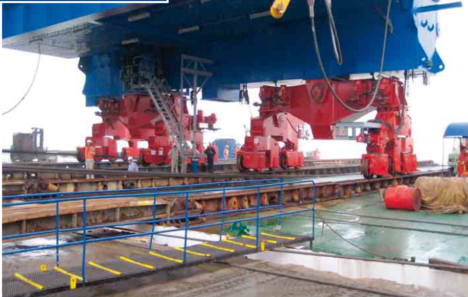
5 Verladung mit gedrehtem Fahrwerk
