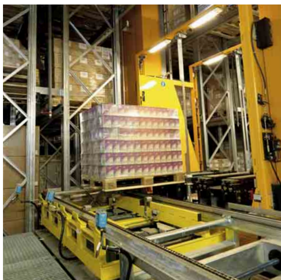
Einlagerung einer Palette in das Hochregal
