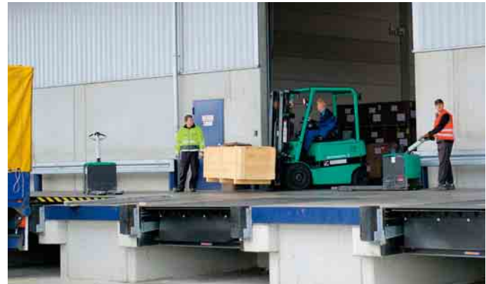
Lkw-Entladung an einer der 17 Rampen: Die Paletten werden mit 2-t-Niederhubwagen von der Ladefläche geholt und mit Elektrostaplern in die Lagerhalle gefahren
