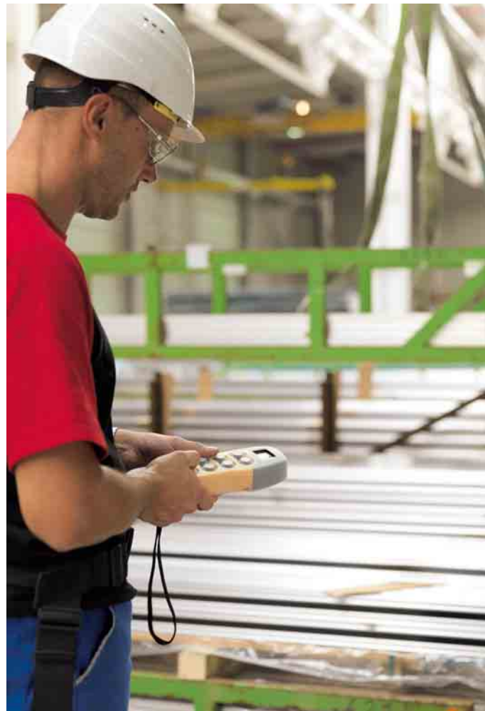
Kransteuerung per Funk: Beim Aluminium-Systemhaus Kawneer werden die Krananlagen auf das System DRC MP umgerüstet
