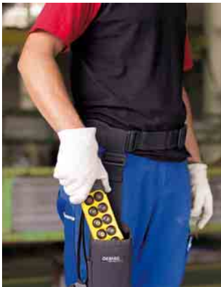
In der Holster-Tragetasche führt der Kranbediener die Funksteuerung immer mit sich
