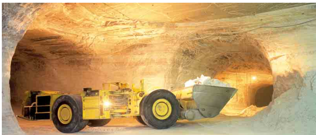
Labyrinth in 1200 m Tiefe: Transport des abgebauten Rohsalzes mit einem 17-t-Diesellader
