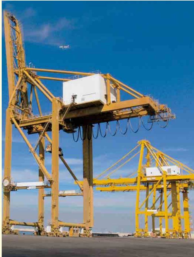
Vorher, nachher: Ship-to-Shore-Krane im Hafen von Dubai wurden von Festoon-Systemen (links) auf die innovative Energieführung Rail Cable Carrier (Kran im Hintergrund) umgerüstet, die für den weiteren Einsatz am neuen Standort Dakar vielfältige Vorteile bietet
