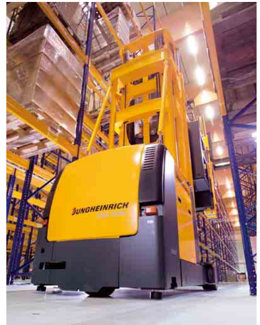
Sichere Fahrzeugsteuerung: Der mit einem RFID-Lese- und Schreibgerät ausgerüstete Kombistapler EKK kommuniziert mit den Transpondern
