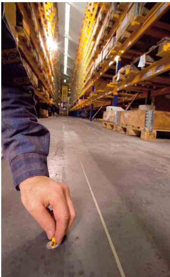
Millimetergroße Transponder bilden die Basis für die komplette Topologie des Schmalganglagers
