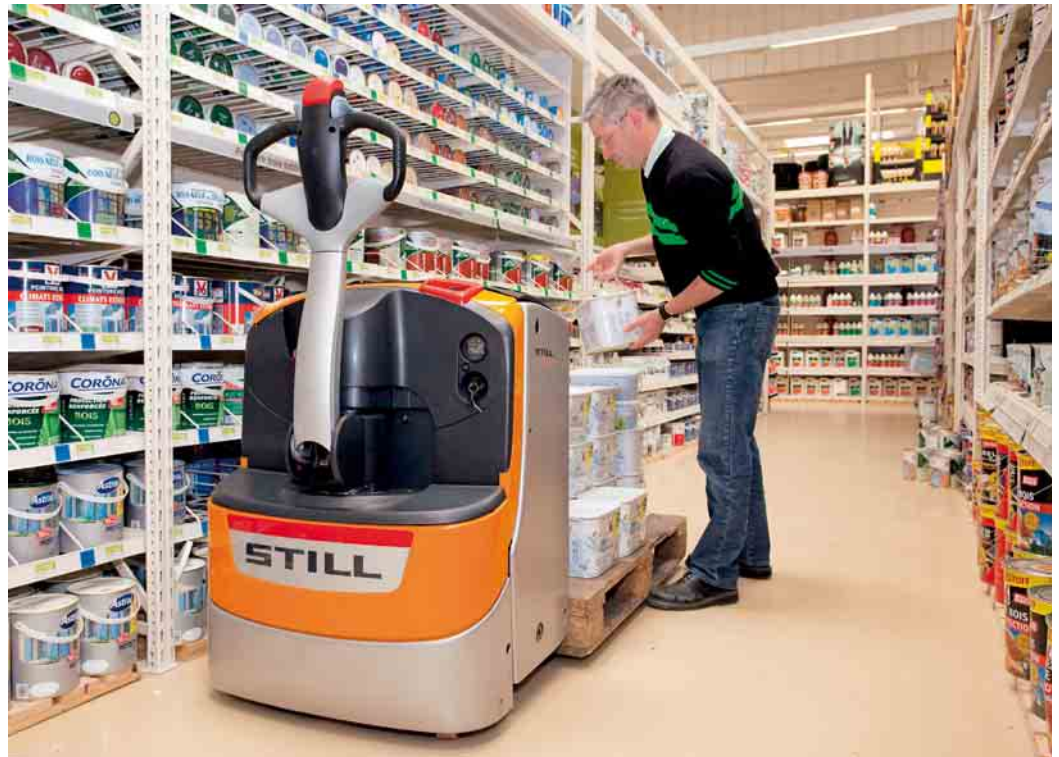
Die neuen Niederhubwagen der Baureihe EXU haben Tragfähigkeiten von 1 600 kg, 1 800 kg, 2 000 kg und 2 200 kg
