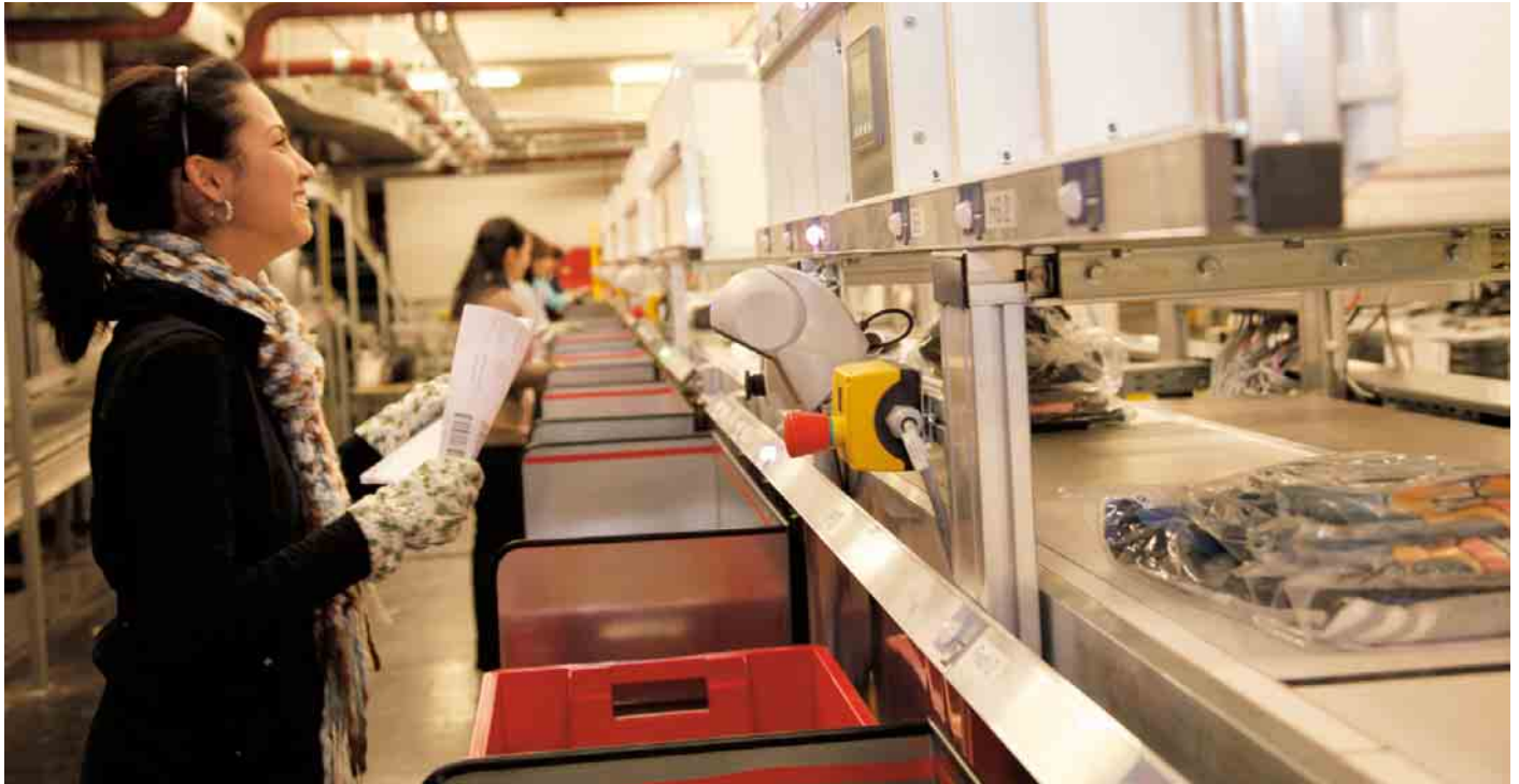
5 Systemgestützt verteilt die Put-to-Light-Anlage die in der Box gesammelten Bestellungen auf die Sortierfächer
