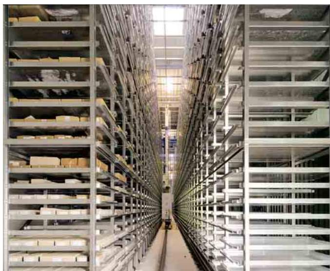
Mit einem automatischen Tablarlager „aus dem Baukasten“ kann Werda die Reaktionszeiten verkürzen, die Kommissionierqualität steigern und mehr Platz für die Produktion schaffen
