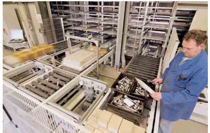
Über ein seitliches Kommissionier-W mit zwei Kommissionierplätzen können Artikel ein- und ausgelagert werden
