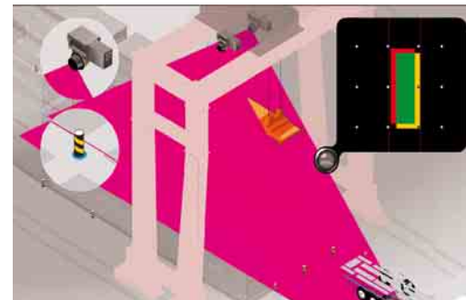
3 Aufnahme eines Containers: Lasercannernpositionen, Positions-Referenzmarken und Scanebenen
