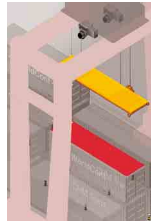
3 Aufnahme eines Containers: Lasercannernpositionen, Positions-Referenzmarken und Scanebenen
