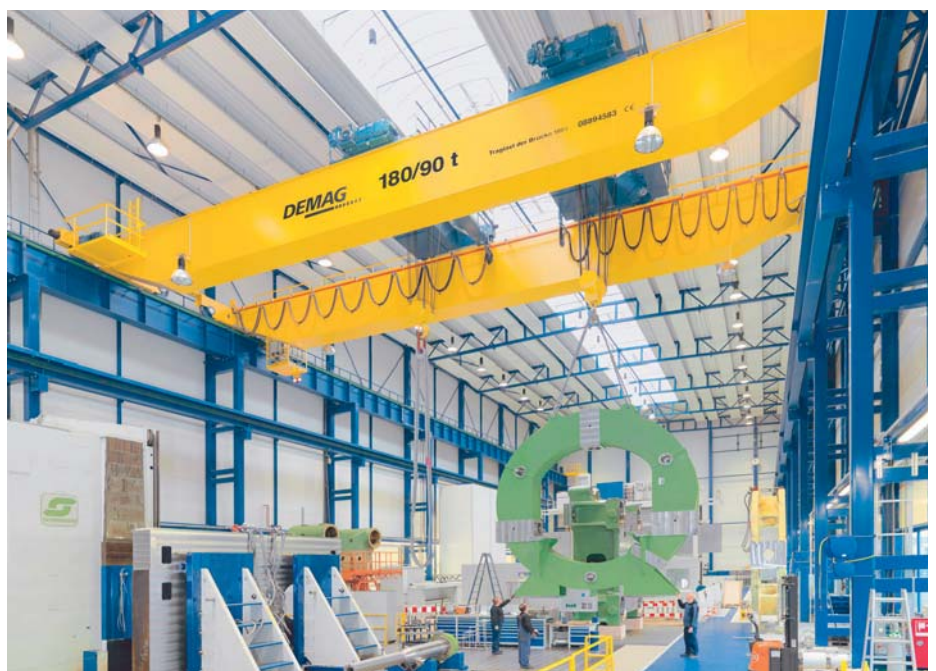
Der Prozesskran übernimmt die exakte Positionierung der bis zu 180 t schweren Bauteile
