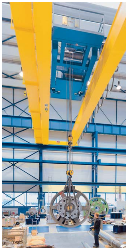
Zwei Hubwerke auf einer Katze: Mit dem Standardkran 32/12,5 t lassen sich auch kleinere Bauteile wenden
