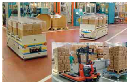
3 Beispiel Pelliconi: Zwei unterschiedliche Fahrzeugtypen für den Karton- und Palettentransport
