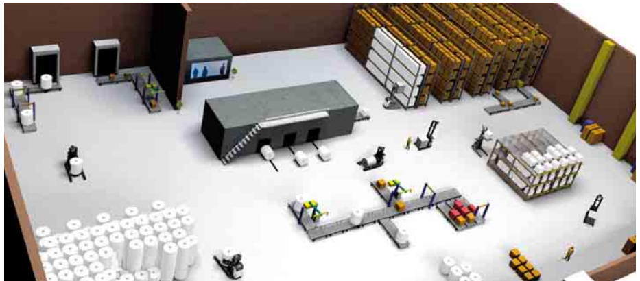
1 Ein FTS verknüpft die Prozessschritte beim Papierrollenhandling (Schema)
