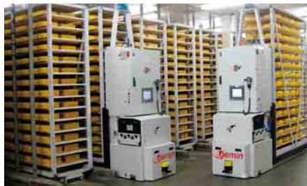
2 Beispiel Campina: Abwicklung der kompletten Intralogistik mit einem FTS in der Käseproduktion
