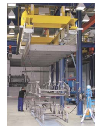
4 Stationäre Hubeinrichtungen an den Vorbereitungsplätzen ermöglichen das Absenken der Teile und das ergonomische Arbeiten ohne zusätzliche Arbeitsbühnen
