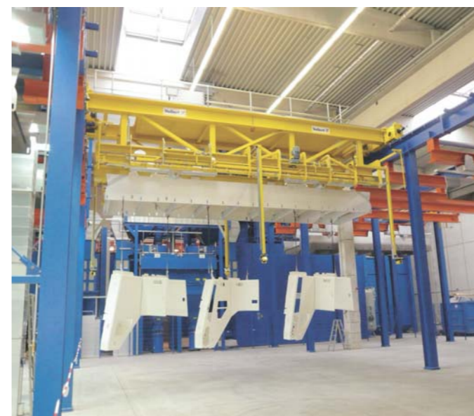
5 Ein Verteilmanipulator (gelb) transportiert die Werkstücke zu den verschiedenen Stationen
