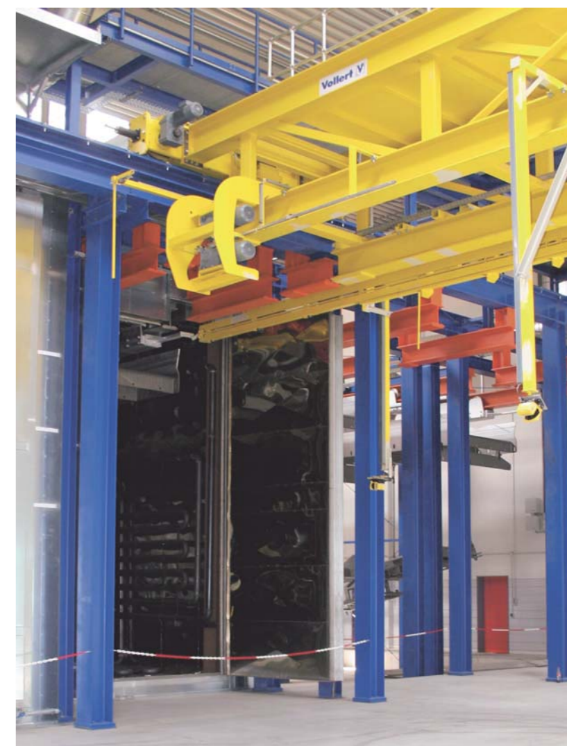
6 Durch die komplette bauliche Trennung von Transport- und Ofenstahlbau werden Wärmebrücken und Energieverluste vermieden. Auch bei schwersten Lasten ist eine Spaltüberbrückung möglich
