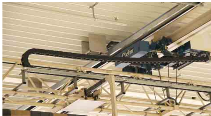
Zuverlässig: Seit 15 Jahren werden an den Hallenkranen Energieketten vom Typ E4/0 in Zick-Zack-Version zur Verbindung von Hubeinheit und Greifer eingesetzt
