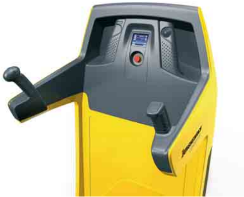
9 Beidseitiger Bedienstand; rechter Griff mit den Funktionen Fahren und Lenken, linker Griff mit den Funktionen Heben, Senken und Hupen
